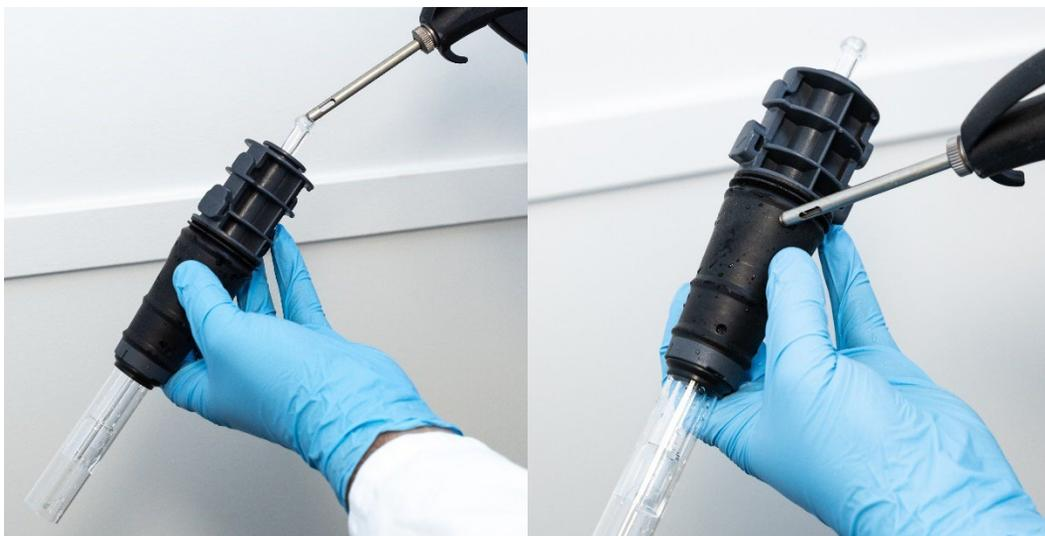
图 18A 和 B. 使用压缩空气、氩气或氮气干燥炬管。
