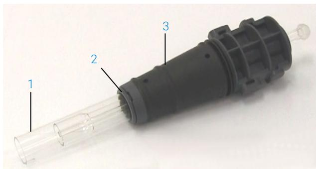
图 3.可拆卸式炬管组成：1.炬管，2.顶部密封垫，3.炬管体
