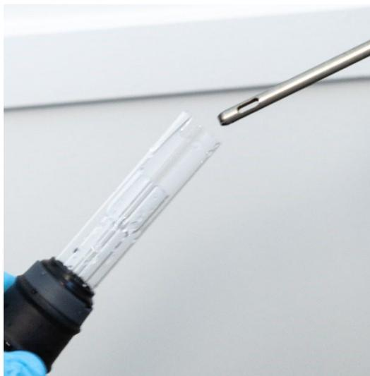
**Figura 19.** Paso de aire comprimido, argón o nitrógeno limpios a través del extremo abierto del conjunto del tubo.
