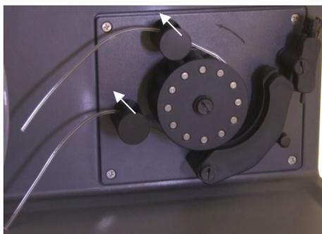
**Figura 13.** Bomba peristáltica con los tornillos de las barras de presión empujadas hacia arriba y barra de presión libremente hacia abajo, lo que permite aflojar los tubos.
