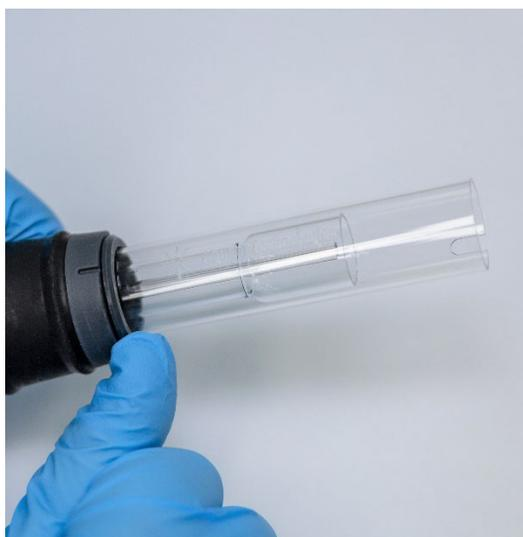
**Figura 9.** Desmontaje del sello superior de una antorcha semidesmontable empujando con la uña del dedo.
