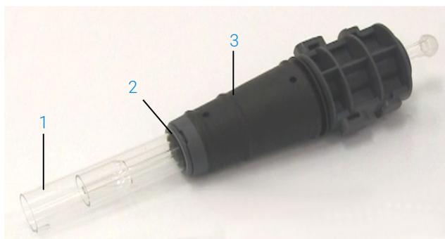
**Figura 3.** Antorcha desmontable: 1. Antorcha; 2. Sello superior; 3. Cuerpo de la antorcha.
