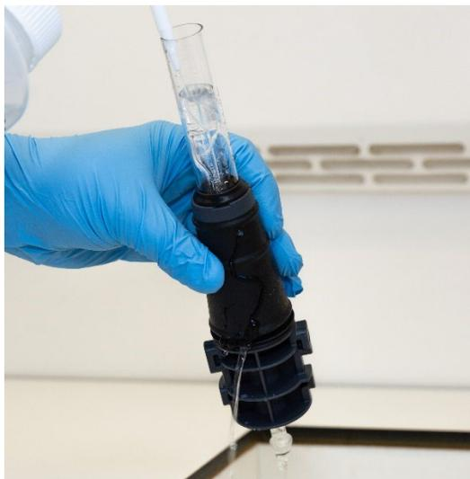
**Figura 16B.** Lavado de los puertos de gas y el conector de rótula con agua desionizada.
