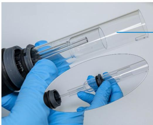
**Figura 11.** Desmontaje del conjunto del tubo de cuarzo del cuerpo de la antorcha.
