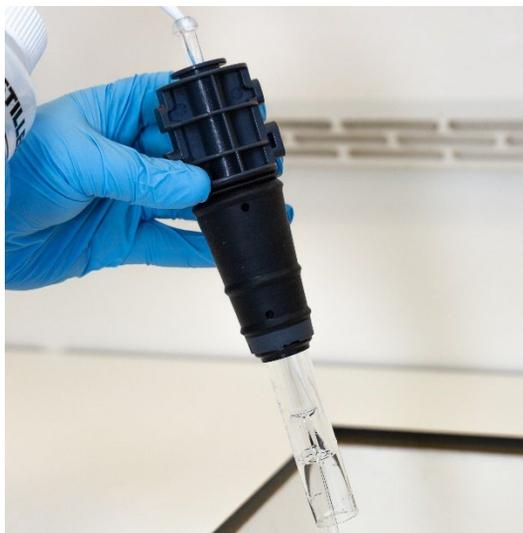
**Figure 16A.** Rincez l'injecteur avec de l'eau déionisée à travers le raccord hémisphérique.
