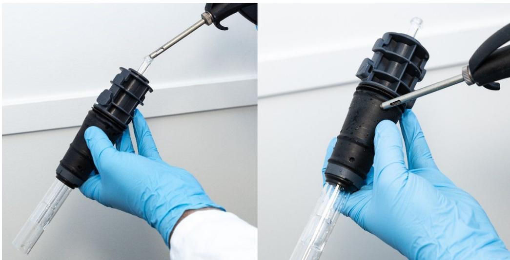
**Figure 18A et B.** Utilisez de l'argon, de l'azote ou de l'air comprimé pour sécher la torche.
