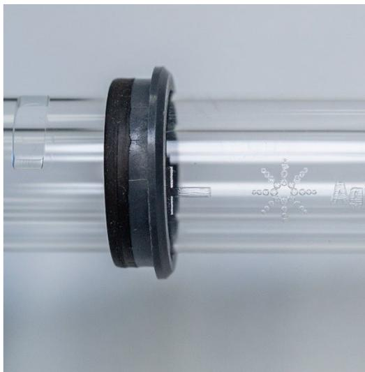
**Figure 5.** Bague supérieure alignée avec le repère d'alignement sur le tube en quartz externe
