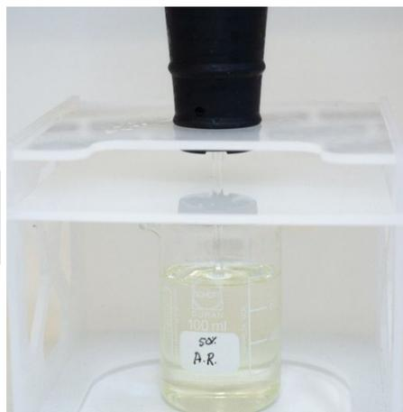
**Figures 15B et C.** Support de nettoyage pour torche monté avec plaques pour torche interchangeables. Injecteur immergé dans l'eau régale.
