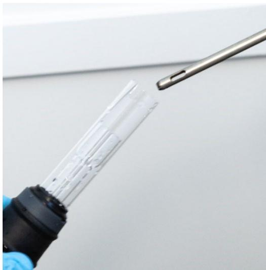
**Figure 19.** Soufflez de l'argon, de l'azote ou de l'air comprimé propre à travers l'extrémité ouverte de l'ensemble de tubes.
