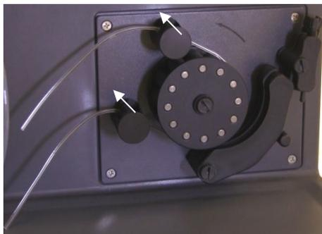
**Figure 13.** Pompe péristaltique avec les vis de la barre de pression poussées vers le haut et la barre de pression complètement rabaissée, permettant de diminuer la tension dans les tubes
