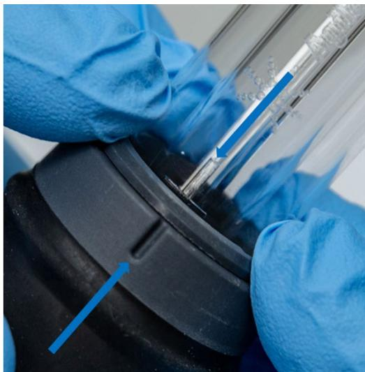
**Figure 7.** Le repère d'alignement sur l'ensemble de tubes en quartz externes doit être aligné avec la rainure sur le corps de la torche
