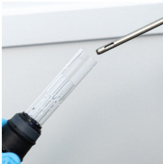
Figura 19. Soffiare aria compressa, argon o azoto puliti attraverso l'estremità aperta del set di tubi.
