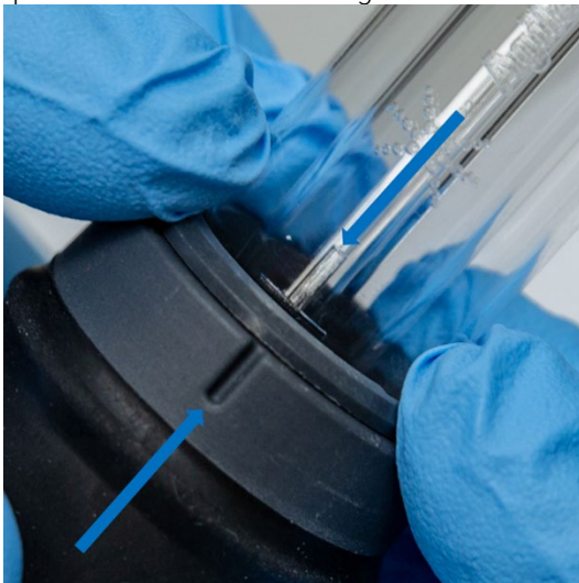
Figura 7. Il contrassegno di allineamento sul set di tubi esterni in quarzo deve essere allineato con la scanalatura sul corpo della torcia
