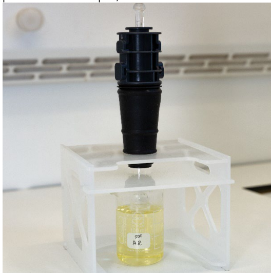
Figura 15A. Immergere la torcia nella soluzione di acqua regia. Assicurarsi che l'iniettore sia immerso nella soluzione.
