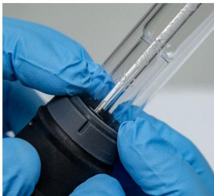
図 8. 上部シールの上端をしっかりと押して、上部シールが適切に取り付けられていることを確認します
