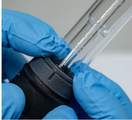
그림 8. 상단 모서리를 단단히 눌러 실패가 올바르게 장착되었는지 확인합니다.
