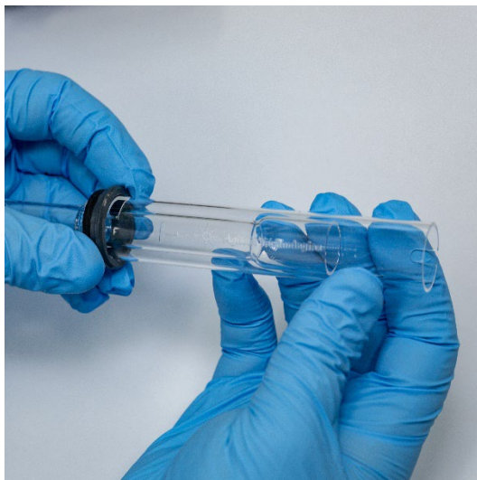
그림 4. 석영 외부 튜브 세트에 다시 장착되는 상단 씬
