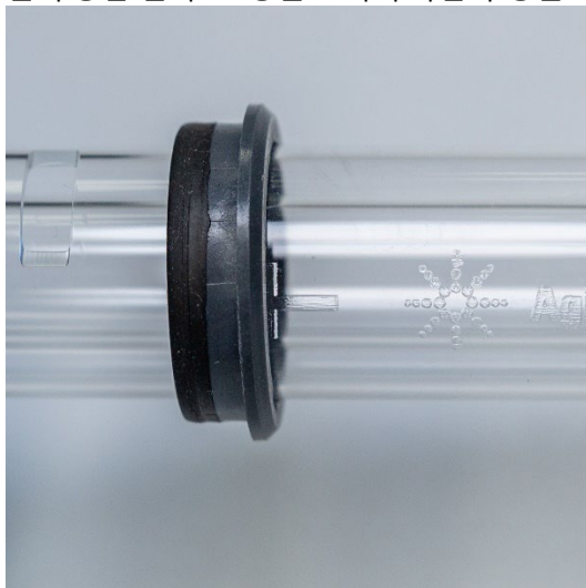
그림 5. 석영 외부 튜브의 정렬 표시와 정렬된 상단 씬
