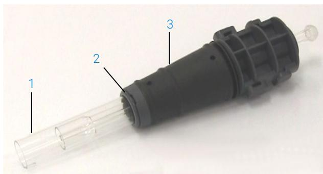
Figure 3. Torche amovible avec : 1. Torche, 2. Bague supérieure et 3. Corps de la torche.
