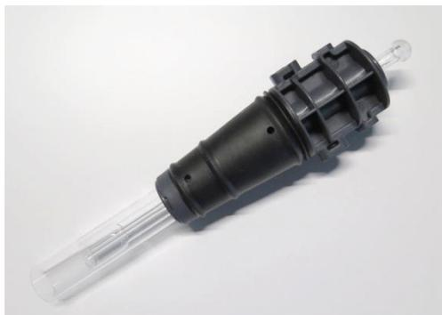
**Figure 14.** Composants de la torche avec : 1. Embout hémisphérique, 2. Ports de gaz, 3. Bague de fixation de la torche (torche amovible uniquement), et 4. Tube externe de la torche
