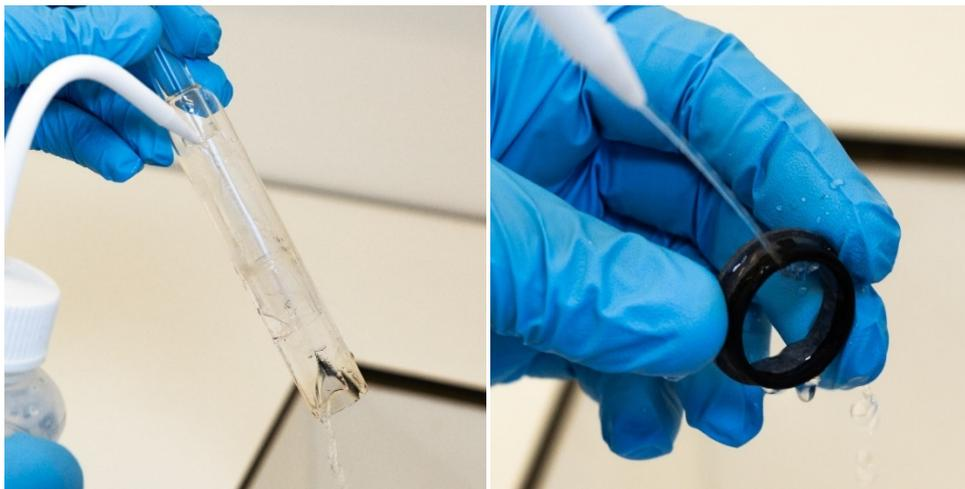
**Figure 17A et B.** Rincez l'ensemble de tubes de quartz et la bague supérieure avec de l'eau déionisée.
