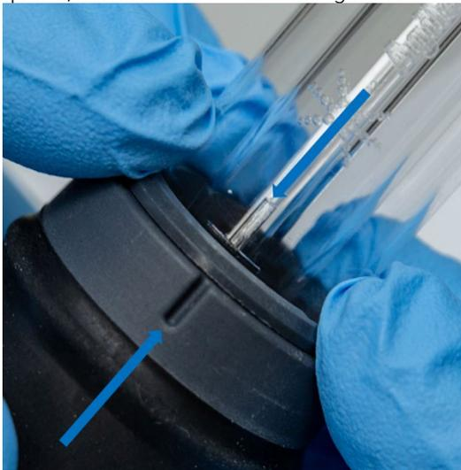
**Figure 7.** Le repère d'alignement sur l'ensemble de tubes de quartz doit être aligné avec la rainure sur le corps de la torche.
