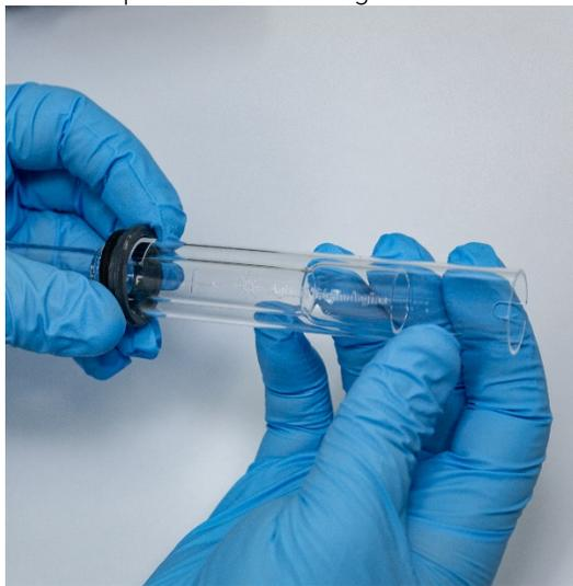
**Figure 4.** Bague supérieure mise en place sur l'ensemble de tubes de quartz.
