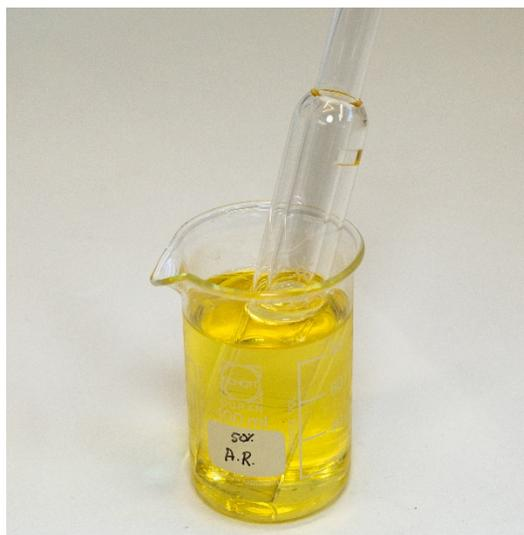
**Figure 15D.** Ensemble de tubes de quartz immergé dans l'eau régale.
