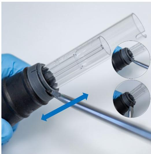
**Figure 10.** Retrait de la bague supérieure à l'aide d'un tournevis à large tête plate.
