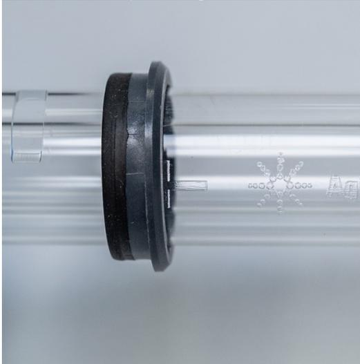
**Figure 5.** Bague supérieure alignée avec le repère d'alignement sur le tube de quartz externe.
