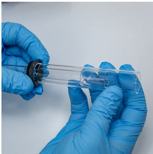
그림 4. 석영 외부 튜브 세트에 다시 장착되는 상단 씰
