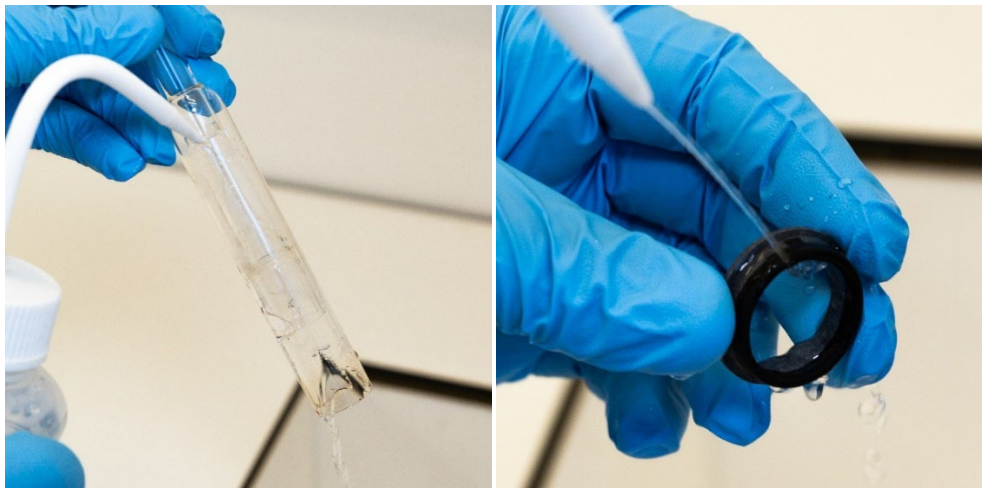
그림 17A 및 B. 석영 외부 튜브 세트와 상단 씰을 탈이온수로 행굽니다.
