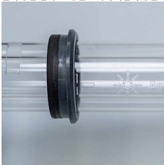
그림 5. 석영 외부 튜브의 정렬 표시와 정렬된 상단 씰
