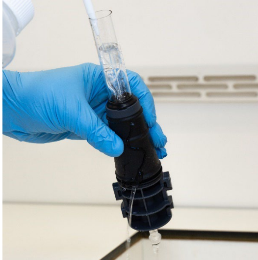
그림 16B. 가스 포트 및 볼 조인트 커넥터를 탈이온수로 세척합니다.
