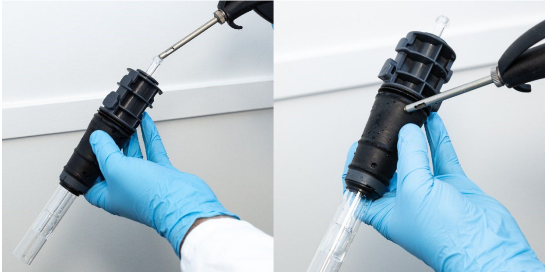
그림 18A 및 B. 토치를 건조하려면 압축 공기, 아르곤, 질소를 사용합니다.
